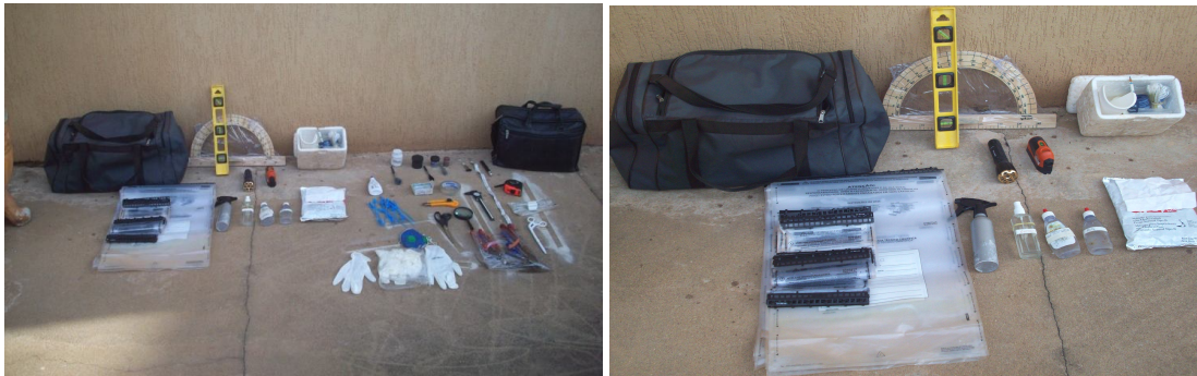
Figura 27. Apetrechos que compõem normalmente o material de trabalho do perito de campo, desde ferramentas convencionais como régua de nível e transferidor para cálculo de desnível, invólucros, luvas, lupa, trenas até reagentes para impressões dactiloscópicas, constatação e orientação para presença de sangue, como peróxido de hidrogênio, luminol e soro fisiológico. Carga para duas malas médias.
