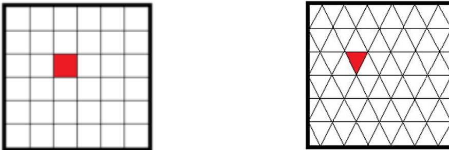
Figura 2: Exemplos de tipos de célula utilizadas no autômato celular, na esquerda célula quadrada e na direita célula triangular.
