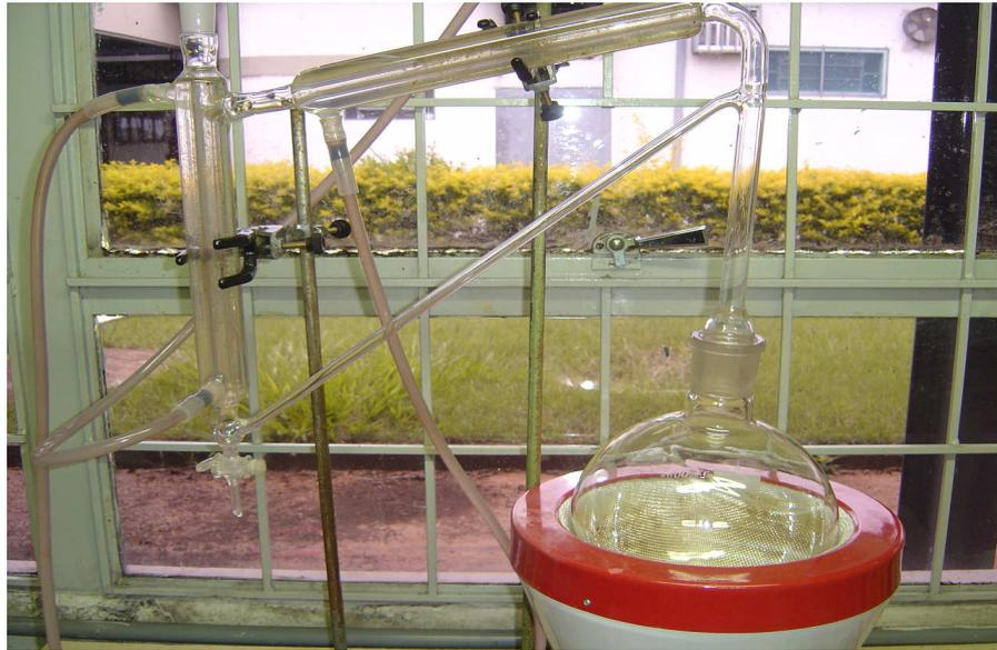
Figura 1 – Hidrodestilador utilizado para extração do óleo essencial das cascas dos frutos
