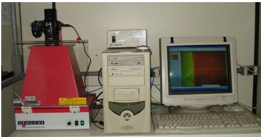
Figura 10 - Sistema de visualização do gel de agarose e de captação de imagem
