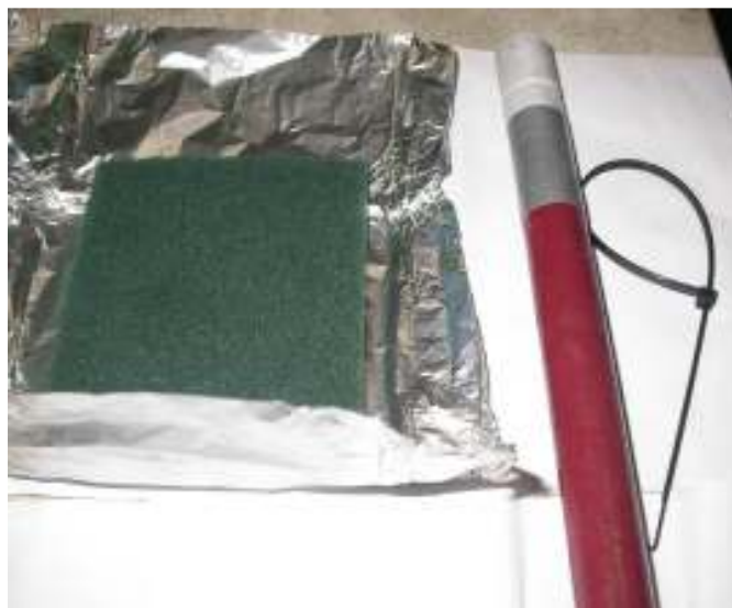
Figura 5 – Peças (esponja abrasiva autoclavada, cabo de madeira encapado com dedo de luva de látex e presilha plástica) para montagem do amostrador utilizado na raspagem de pele dos golfinhos.
