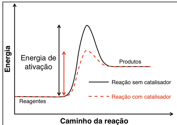
Figura 9: Gráfico representativo do caminho de uma reação. A energia de ativação representa a barreira energética que necessita ser ultrapassada para sua ocorrência. Note a alteração de seu valor na presença de um catalisador. Fonte: Wikimedia Commons.
