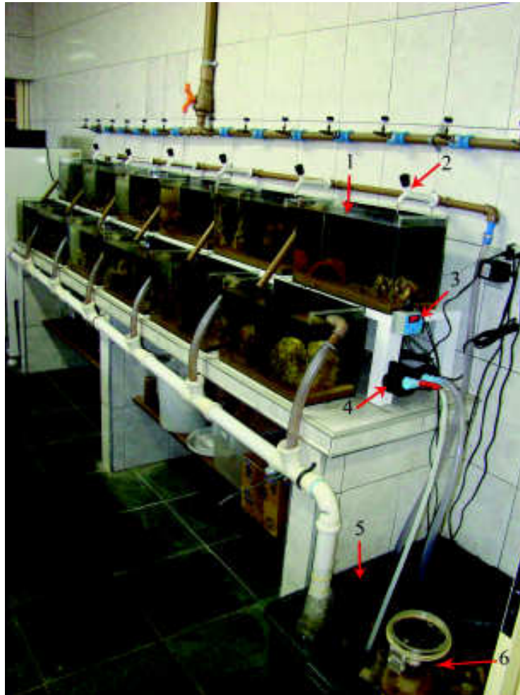
Figura 4: Fotografia do sistema de água recirculante utilizado neste trabalho, para manutenção de espécimes adultos de Stenopus hispidus . 1) aquários com medidas 0,45 m x 0,20 m x 0,30 m; 2) torneiras para retorno da água; 3) controlador digital de temperatura; 4) filtro com lâmpada ultravioleta; 5) sump de recirculação; 6) skimmer .
