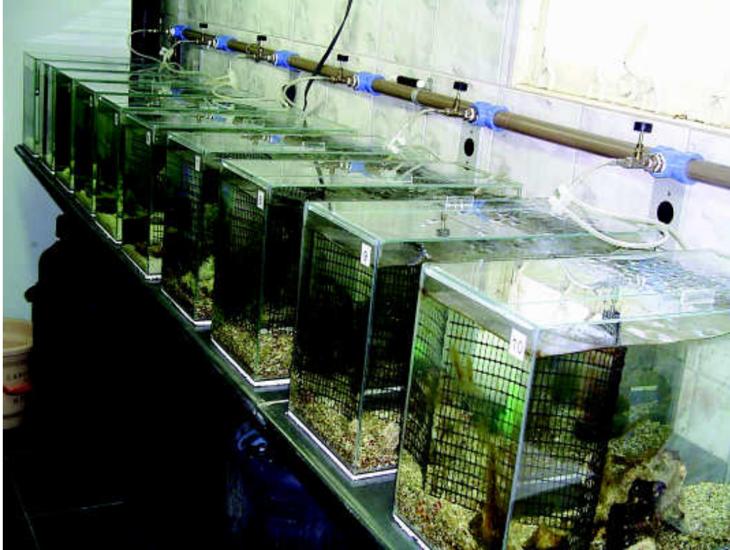
Figura 2: Aquários utilizados para manutenção de casais adultos de Stenopus hispidus (0,45 m x 0,20 m x 0,30 m), com filtro interno de espuma e sistema de aeração central.
