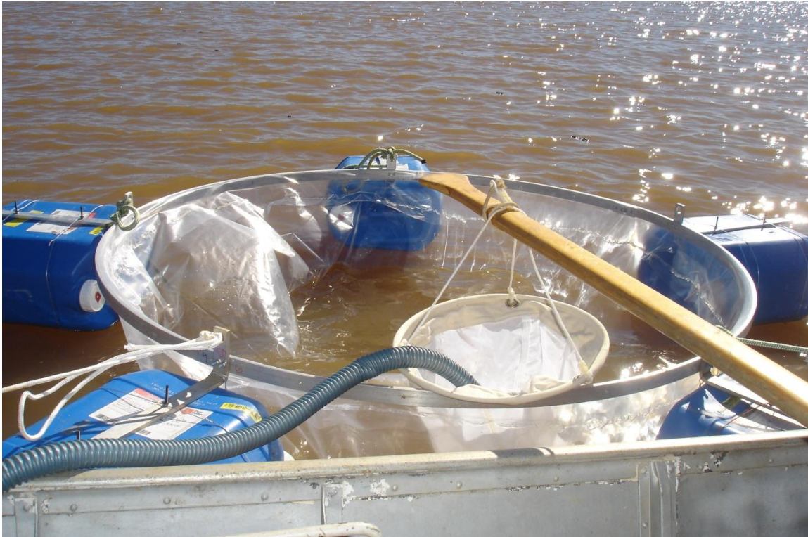
Figura 5 - Enchimento de enclosure . Detalhe: cano da bomba despejando a água dentro da rede de zooplâncton com abertura de malha de 50µm.
