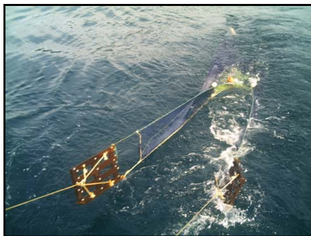
Figuras 9 e 10. Rede de “otter trawl” utilizada para efetuar as amostragens nas áreas mais rasas da enseada.
