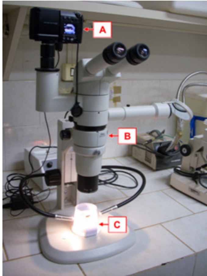
Figura 3. Câmera Nikon ® , modelo Coolpix 4500, acoplada ao (B) microscópio estereoscópico Nikon ® , modelo SMZ 1000; (C) Copo plástico para difusão da luminosidade.
