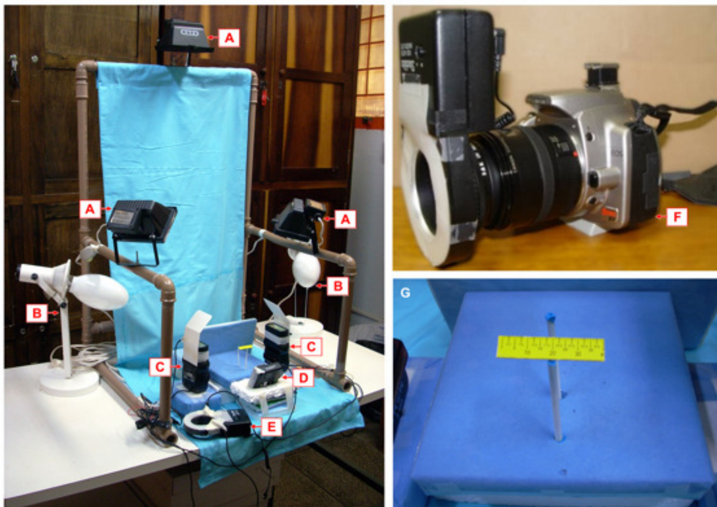
Figura 2. Estúdio caseiro. (A) Luminárias alógenas de 150 watts; (B) Lâmpadas de mercúrio mistas de 250 watts; (C) Flashes TRON ® S-300S; (D) Flash TRON ® 100S; (E) Ring-flash STARblitz ® 1000 AUTO Macro-lite; (F) Câmera digital Canon ® , modelo EOS Rebel XT; (G) Placa de isopor com tubo plástico para fixação dos insetos.
